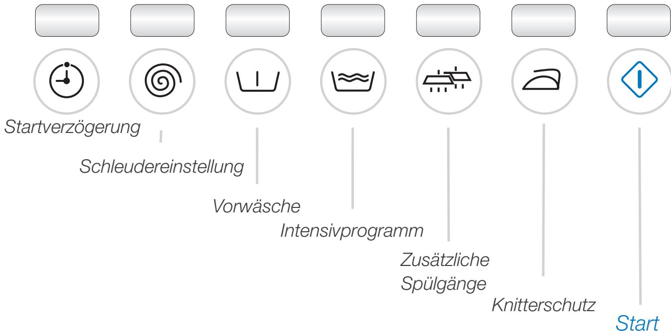
**NB:** Die Waschmaschine programmiert die für die jeweilige Gewebeart am besten geeignete Schleuderdrehzahl.
